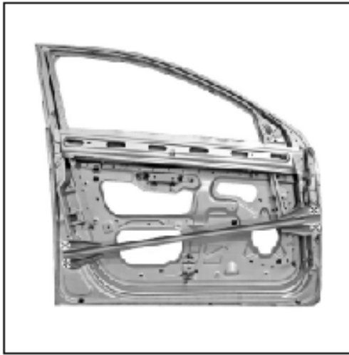
پس از جداسازی نقاط جوشکاری شده، پوشش داخلی
