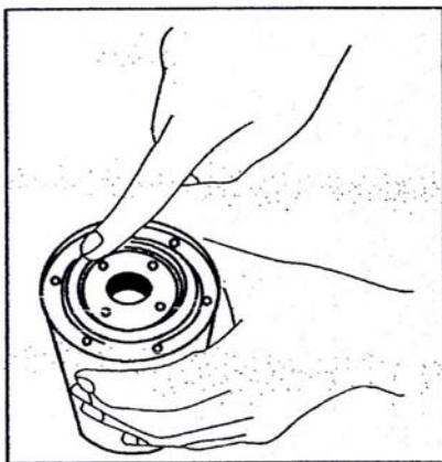
شکل ۴-۲۰-۵۲: نصب المان فیلتر روغن
