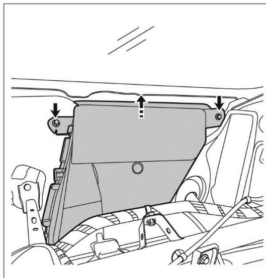
(i) پیچ‌های اتصال کنترلر قفل درب مرکزی را باز کرده و کنترلر را در محلی قرار دهید که در معرض ضربه ناشی از پیاده کردن مجموعه HVAC قرار نگیرد.
