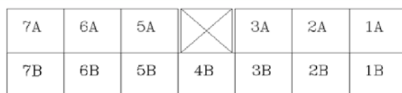
TO INST GR کانکتور ارتباط دسته سیم اصلی به دسته سیم داشبورد XFTIGR
