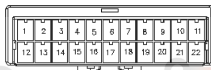
کانکتور دسته سیم اصلی به دسته سیم داشبورد 1 XFT11
